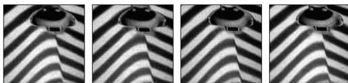
Eine orthogonale Anwendung des Sinusmusterprofils auf die Oberfläche ergibt mehrdimensionale Krümmungs- und Neigungsdaten.
