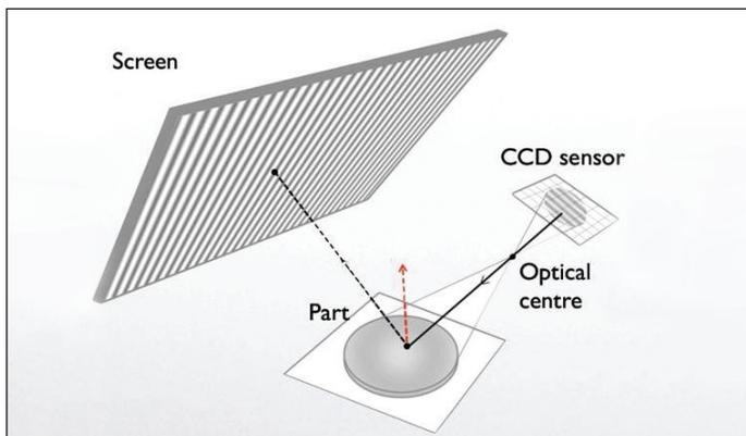
Durch die schrittweise Bewegung ("stepping") der Wellenform wird eine exakte Messung jedes Punktes der Oberfläche durch den entsprechenden Bildpunkt der Kamera möglich. Die geometrische Verbindung zwischen Display, Oberfläche und Kamera nutzend können reflektierte und räumlich modellierte Lichtstrahlen die Richtung der Senkrechten an jedem Punkt der Oberfläche berechnen und damit eine Profil zu diesem Punkt erstellen.
