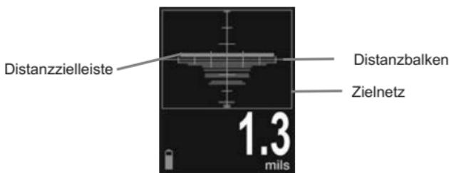
Bewegen Sie die Sondenspitze näher an das Ziel heran, während Sie auf das Messgerätedisplay achten und richten Sie den **Distanzbalken** auf die **Distanzzielleiste** aus. Die optimale Distanz zwischen der Sondenspitze und der Oberfläche des aufgetragenen Pulvers beträgt 2 cm. Stellen Sie sicher, dass der **PosiTTest-PC** senkrecht zur Oberfläche gehalten wird.
