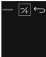
**9.** Sélectionner l'option **2-Pt Adjust** dans le menu de l'instrument, puis choisir l'option .
