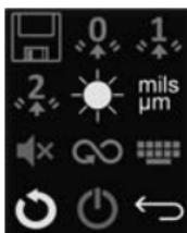
**Speichermodus:** Schaltet den **Speichermodus EIN**. Das Messgerät speichert einen gleitenden Mittelwert für bis zu 999 Messungen und behält diesen bei. Die gespeicherten Messungen können mithilfe der PosiSoft-Desktop-Software heruntergeladen werden (S. 10). Wenn der **Speichermodus** eingeschaltet ist, erscheinen folgende Menüoptionen:
