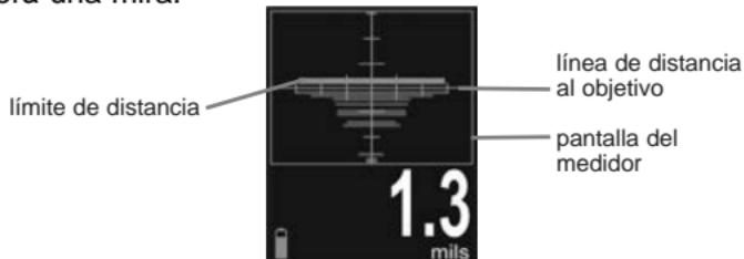
Con la vista puesta en la pantalla del medidor, mueva el extremo de la sonda cerca del objetivo, alineando el **límite de distancia** con la **línea de distancia al objetivo**. La distancia óptima para la medición es de 2 cm (3/4") entre el extremo de la sonda y la superficie del polvo aplicado. Compruebe que el **PosiTest PC** está perpendicular a la superficie.
