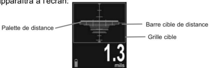
Tout en observant l'affichage de l'instrument, déplacer la sonde à proximité de la cible, tout en alignant la **palette de distance** avec la **barre cible de distance**. La distance optimale pour la mesure est de 2 cm (3/4 po.) entre la tête de la sonde et la surface de la poudre appliquée. Veiller à maintenir le **PosiTest PC** perpendiculaire à la surface.
